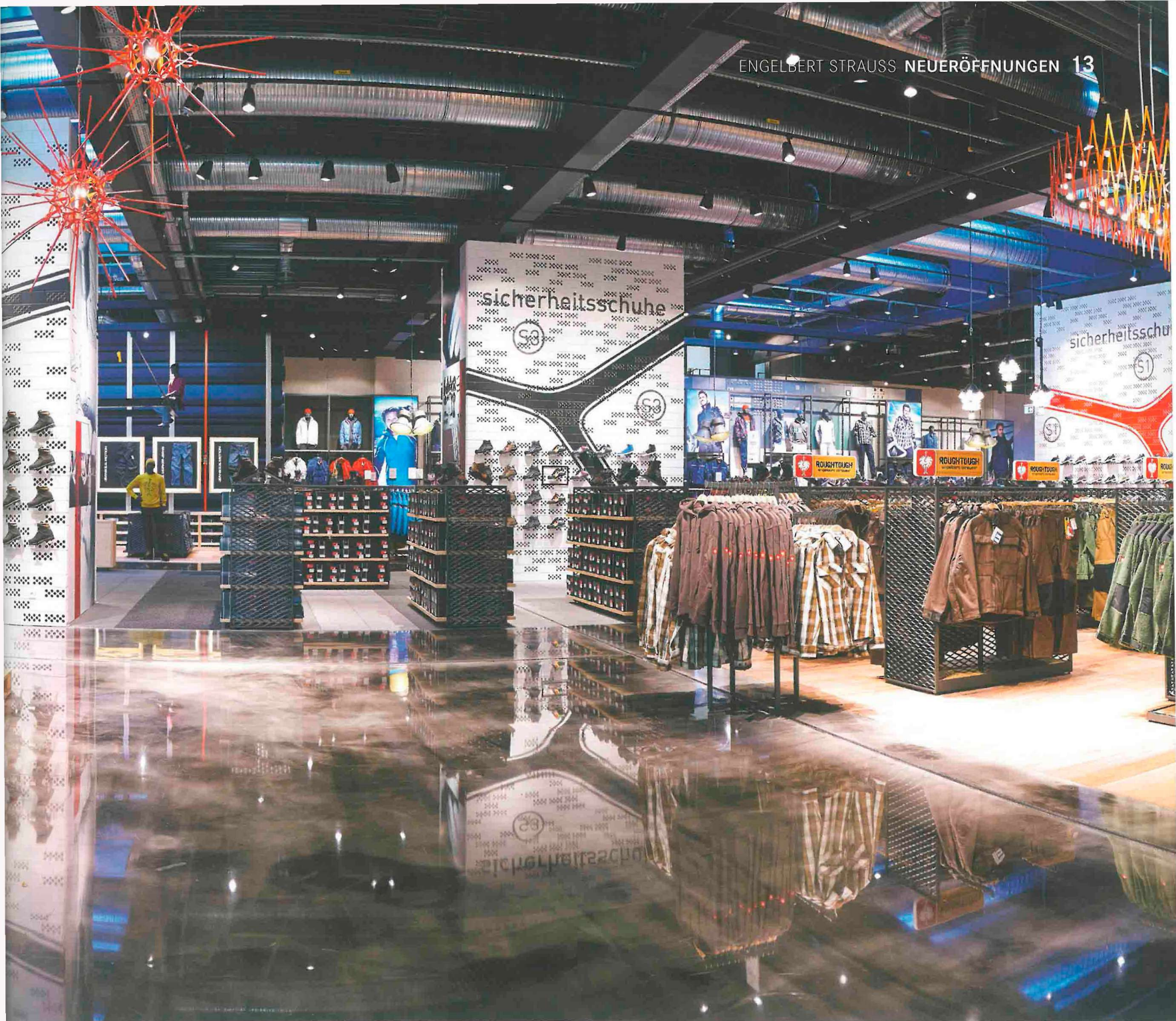
Deko-Podeste aus Europaletten, darauf immer wieder verschiedene Szenarien aus der Arbeitswelt. Der hochglänzende Boden besteht aus Estrich mit Epoxidharzbeschichtung
